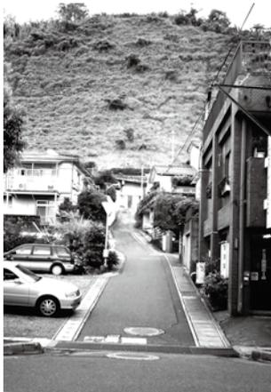
鹿児島市武のシラスの急崖。崖の手前の緩斜面（奥に続く道路の部分）は、過去の崩壊堆積物が作った地形で、薩摩藩では開発が規制されていたエリア。1993年鹿児島豪雨災害ではこの急崖が崩壊し、土砂がこの緩斜面を覆った。
